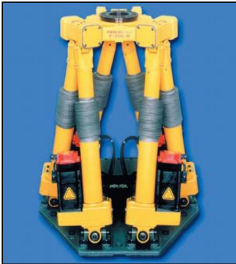
Figura 2-3 El F-200iB es un robot paralelo de seis grados de libertad para aplicaciones en manufactura y procesos de ensamble en la industria automotriz (cortesía de Fanuc Robotics American Inc.) (Fanuc, 2005).
