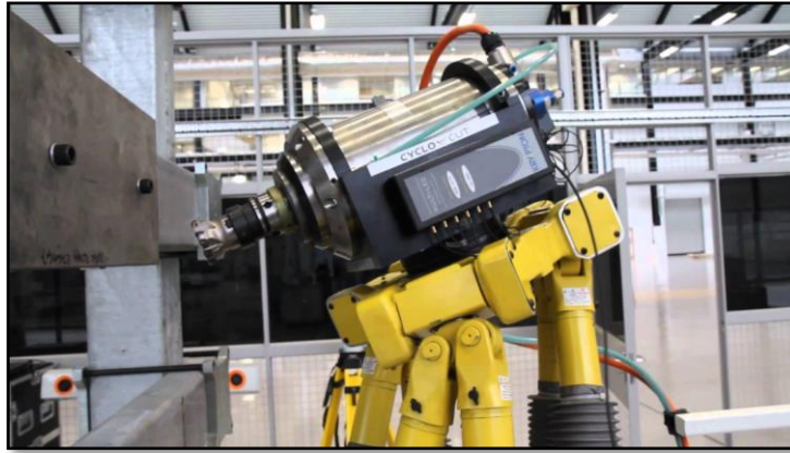
Figura 2-4 F-200iB en una aplicación de manufactura (cortesía de Fanuc Robotics American Inc.) (Fanuc, 2005).
