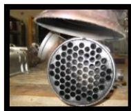
Imagen 1. Corte con láser de tapa de intercambiador.
