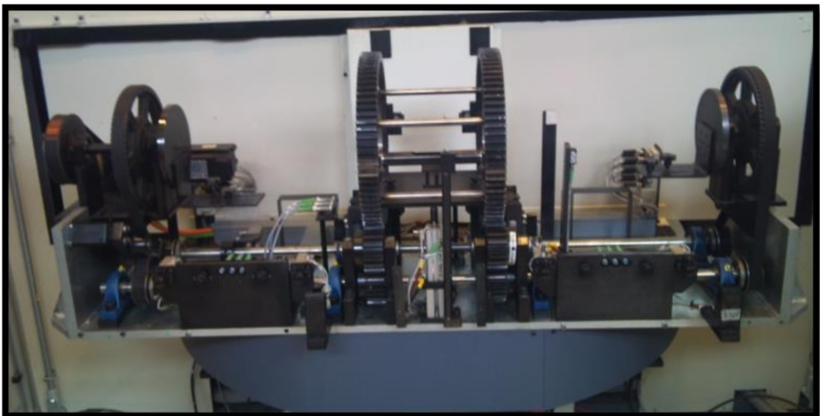
Imagen 55. Ensamble de dispositivo de sujeción y giro 1.
