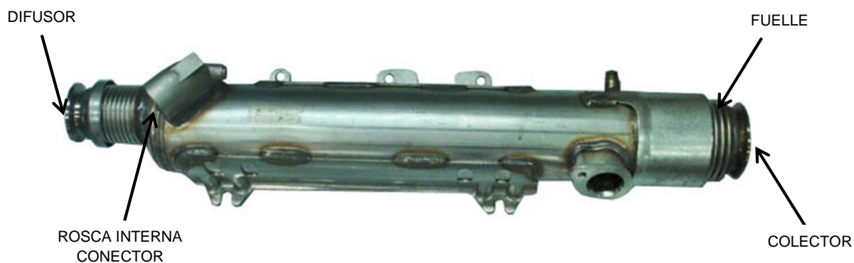
Imagen 8. Partes de inspección intercambiador.
