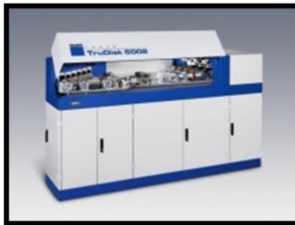
Imagen 61. Fuente de potencia láser true disk 1000 W.
