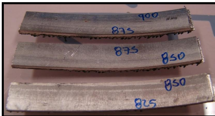
Imagen 63. Corte de 825 a 900 Watts.
