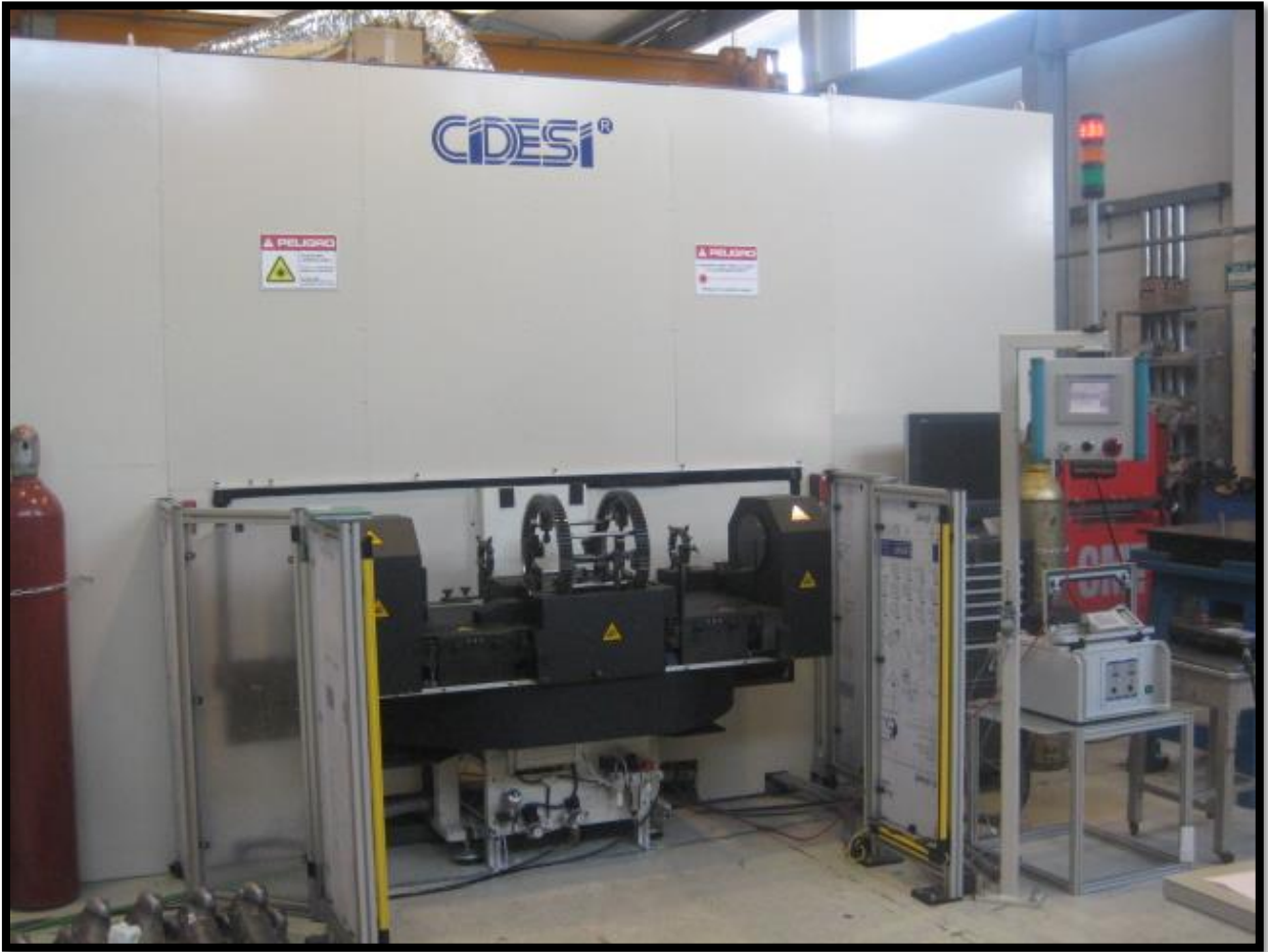
Imagen 82. Celda de corte láser y soldadura CMT.
