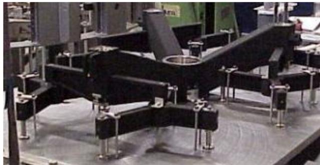
**Figura 2.3 Soporte de carga. [10] (Gran Telescopio CANARIAS)**
