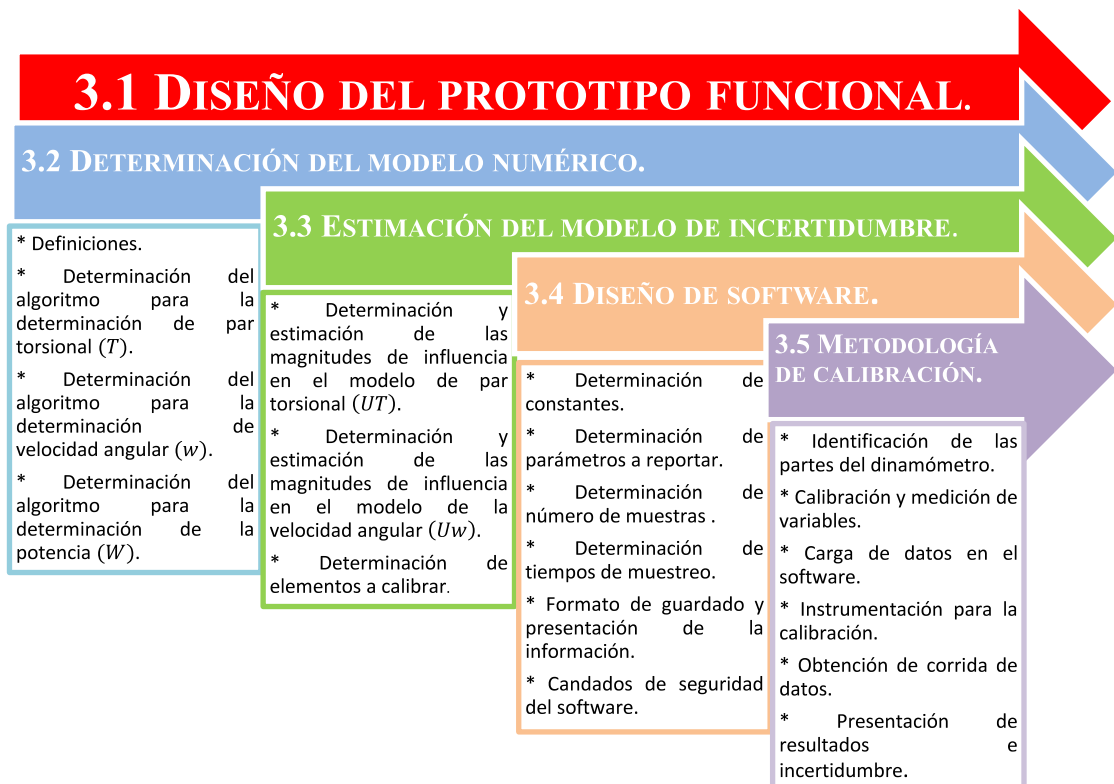
Figura 3.1. Diagrama a Bloques del Prototipo Funcional.
