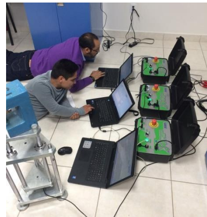
Imagen 66. Los tres sistemas midiendo al mismo tiempo de manera independiente pero recibiendo la misma señal de la celda de carga y del tacómetro en el CVV y en las pruebas de laboratorio.
