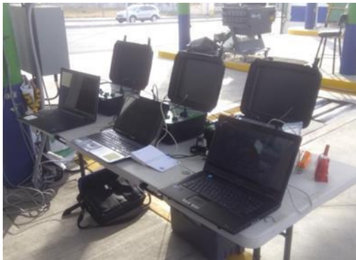
Imagen 66. Los tres sistemas midiendo al mismo tiempo de manera independiente pero recibiendo la misma señal de la celda de carga y del tacómetro en el CVV y en las pruebas de laboratorio.
