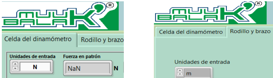
Imagen 40. Pantalla para cargar las unidades de fuerza y de medición de la longitud del brazo de palanca y del diámetro del rodillo.
