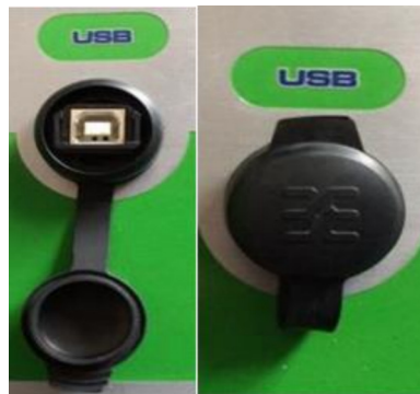
Imagen 48. Puerto USB tipo B para comunicación con la PC.
