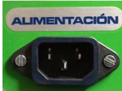
Imagen 49. Entrada de alimentación eléctrica.
