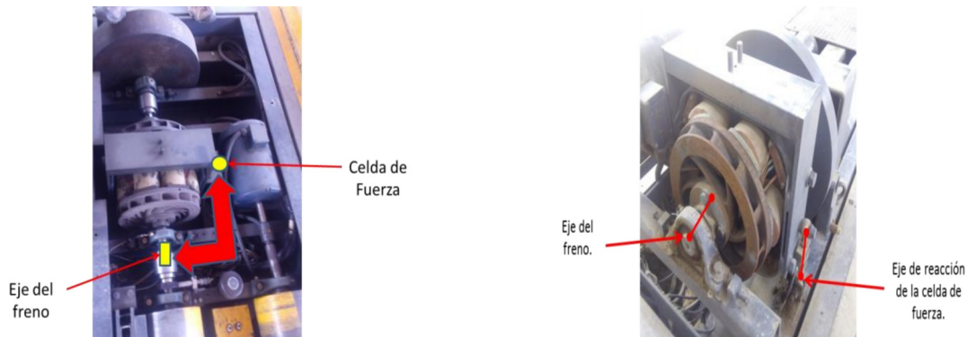
Imagen 20. Imagen de los ejes de acción de la celda de fuerza y el eje de rotación del sistema de frenado.
