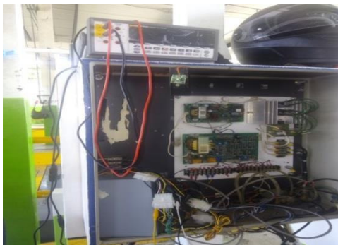
Imagen 53. Búsqueda de señales de entrada de la celda de carga y del tacómetro .
