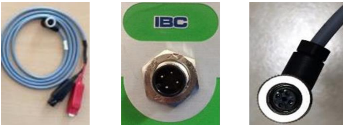
Imagen 42. Cable para conexión de la celda IBC. Entrada para conexión de la celda IBC y conector del cable de adquisición.
