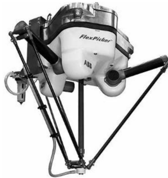
Figura 9 Manipulador paralelo de cadena cerrada; (Merlet, 2006).
