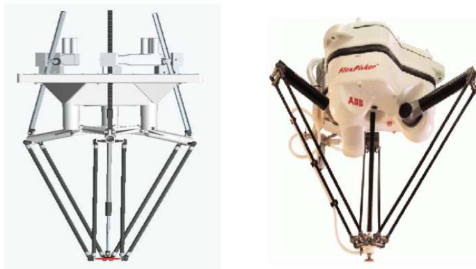
Figura 4 Manipuladores con tres grados de libertad; (Briot & Khalil, 2015).
