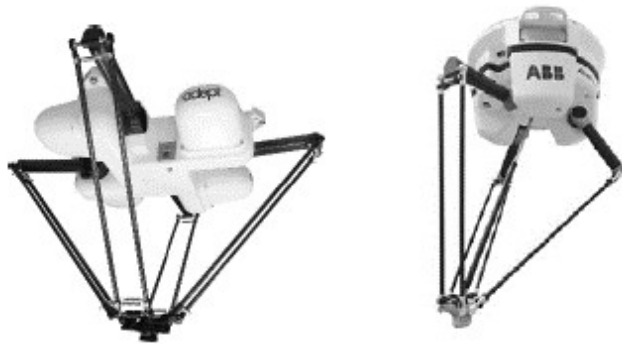
Figura 5 Manipuladores con cuatro grados de libertad; (Serje & Pacheco, 2017).
