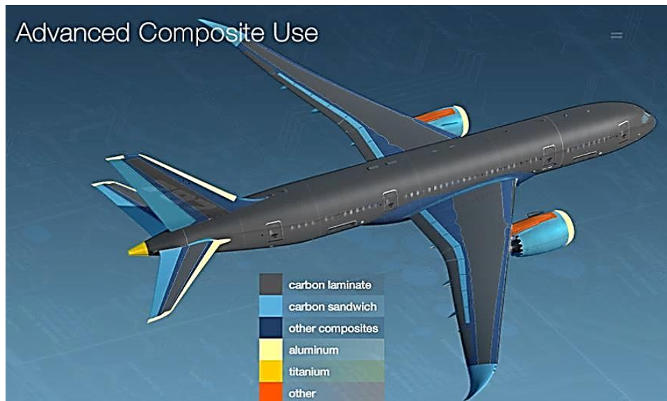
Figura 15 Esquema de la aeronave boeing 787 manufacturada en un 50% de materiales compuestos
