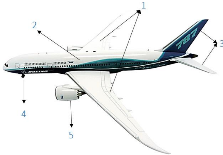
Figura 12 Clasificación de los grupos en los que se subdivide una aeronave
