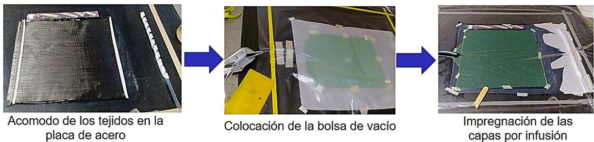
Figura 30 Esquema del proceso de manufactura por infusión
