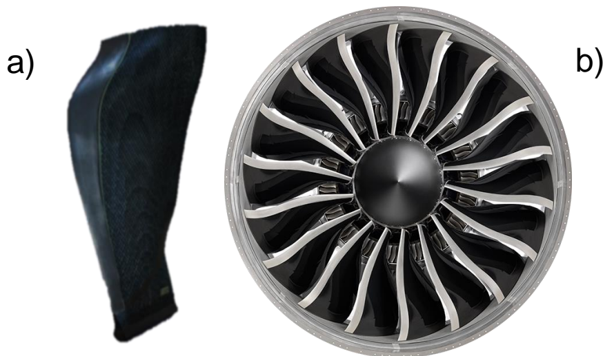
Figura 2 Esquema de: a) Ábalo de fan hecho de fibra de carbono y b) fan del motor hecho de materiales compuestos.
