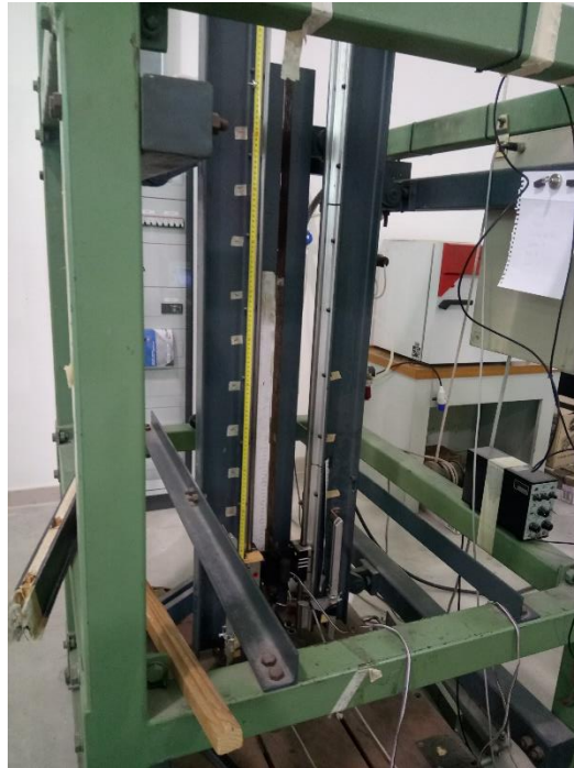
Figura 28 Máquina de ensayos de impacto de baja velocidad de la universidad de Cagliari Italia
