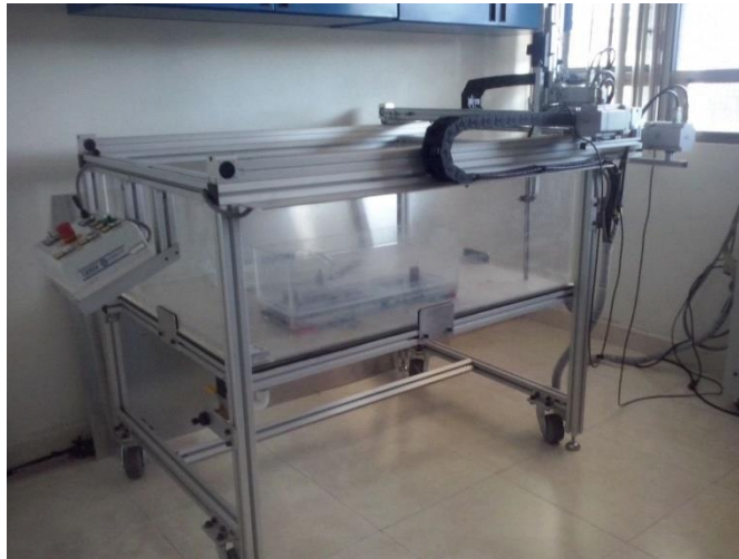
Figura 27 Tina y sistema de ultrasonido C-scan
