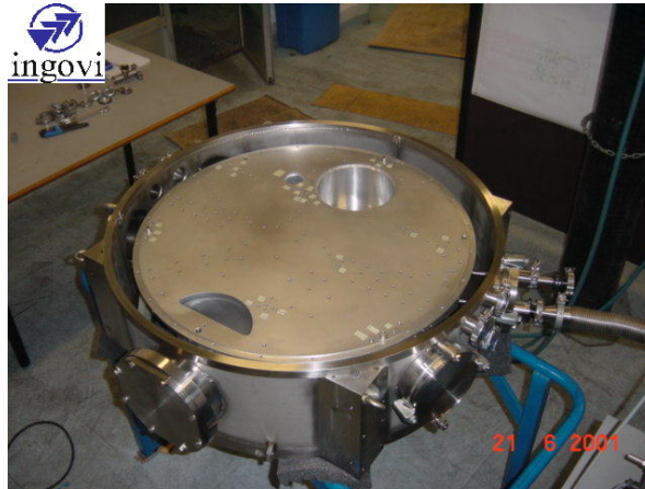
Figura 1-7 Banco óptico montado en anillo central
