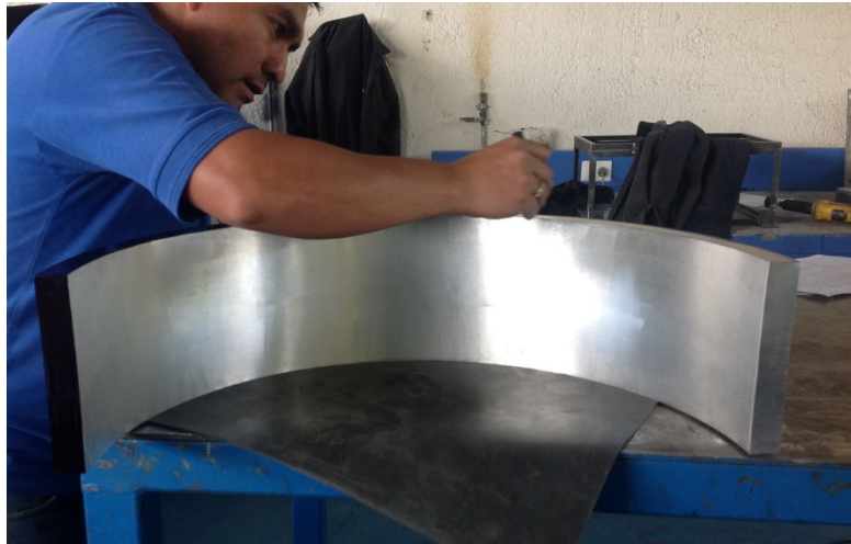
Figura 8-2 Rolado de partes circulares que forman el tanque
