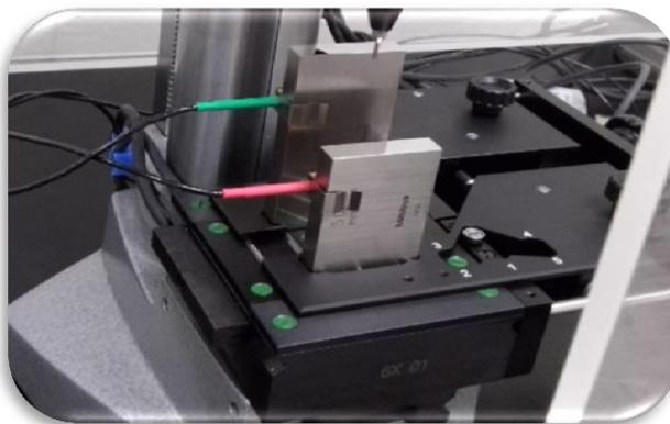
**Fig. 13. Medición de temperatura puntual.**
