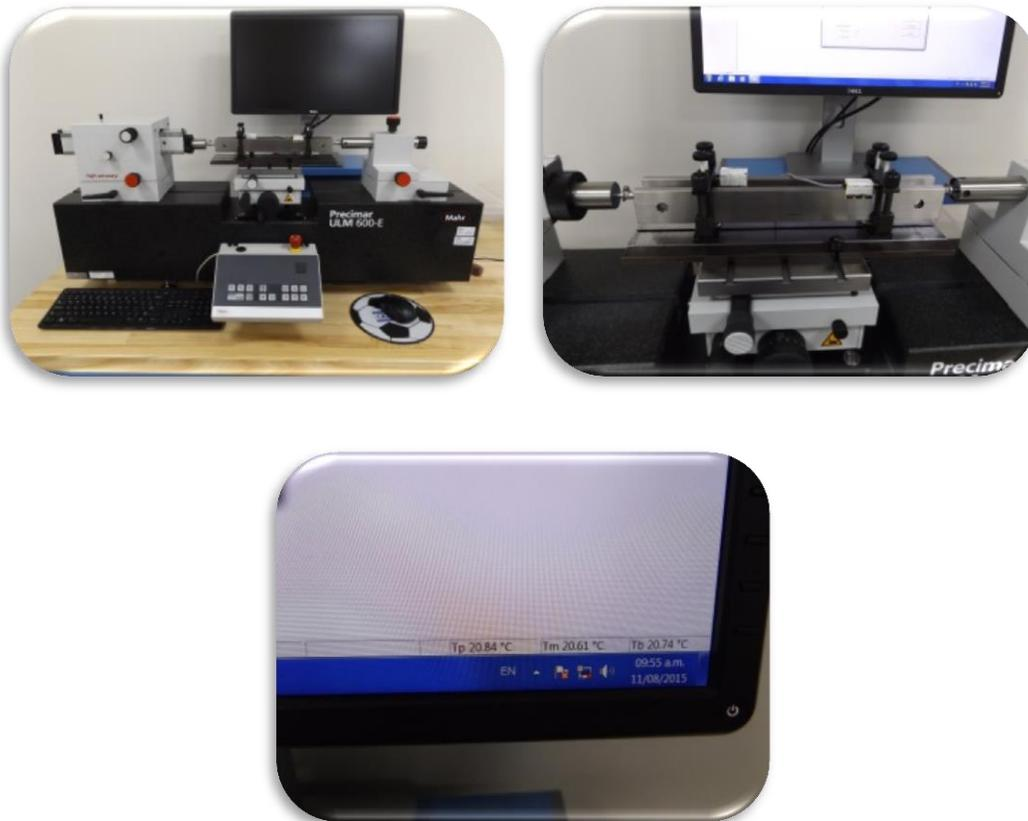
**Figura 29. Sistema para calibración de bloques mayores a 100 mm.**
