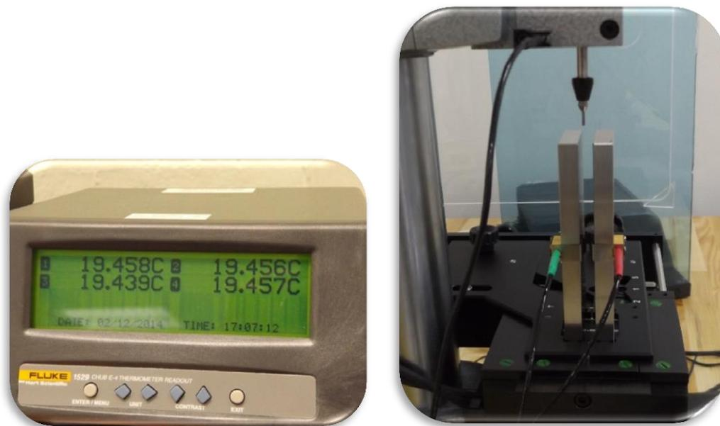
**Fig. 12. Termómetro digital de 4 canales para el censado de la temperatura de los bloques.**
