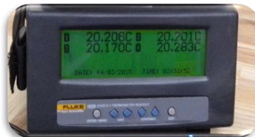
**Fig. 4. Termómetro para el monitoreo y registro de las condiciones ambientales.**
