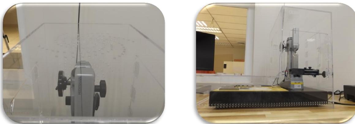
**Fig. 17. Cabinas para calibración de bloques patrón longitudinales**
