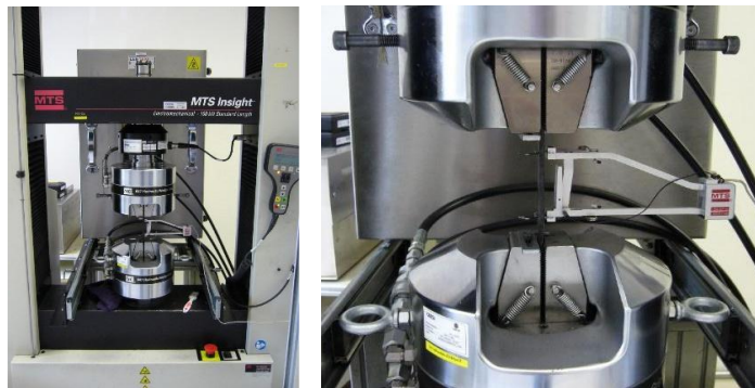
Figura 50 Alineación de probetas con respecto a mordazas de cabezales en MTS.
