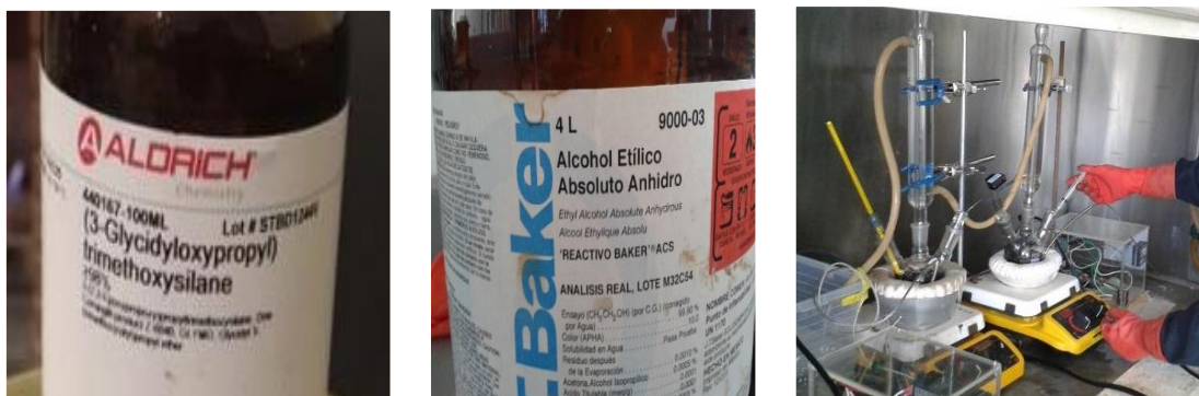
Figura 41 Inyección de diluciones de alcohol etílico y silanos para la funcionalización de las fibras.
