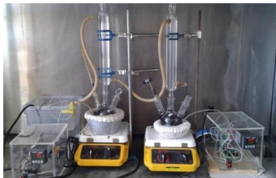
Figura 40 Arreglo de sistema de reflujo.
