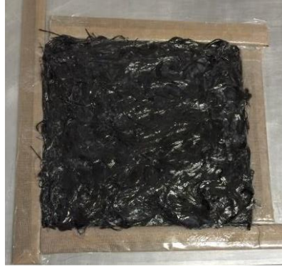
Figura 44 Vaciado de la mezcla del compuesto en el molde.
