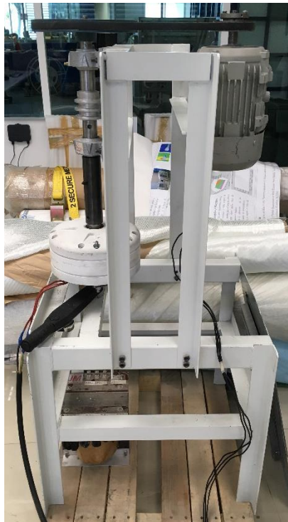
Fig.6.8. Banco de pruebas para simulación de turbinas verticales
