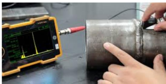
Figura 2: Prueba de Ultrasonido Industrial.[12]
