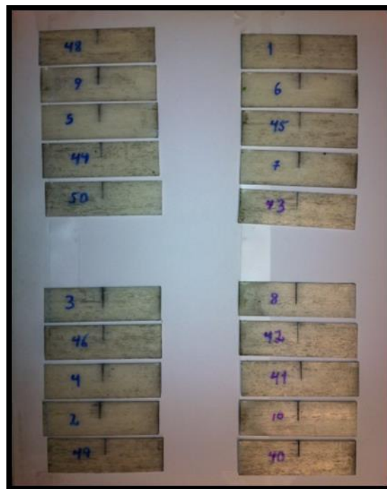
Figura 37.- Probetas útiles después de pruebas de impacto.
