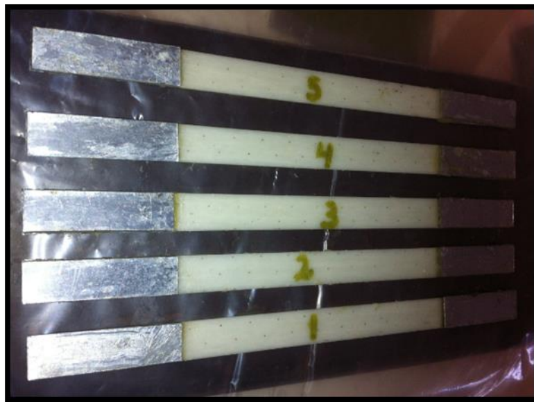
Figura 27.- Probetas de fibra de vidrio con taps de aluminio.
