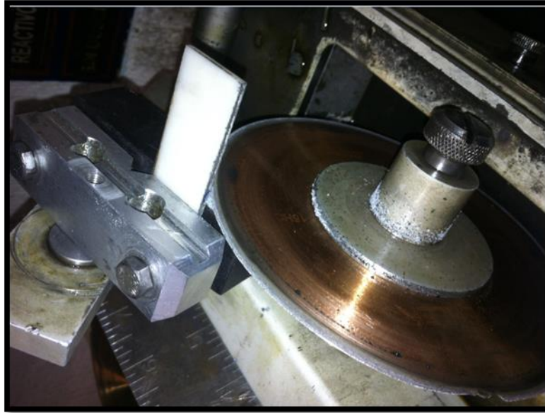
Figura 31.- Corte de la muesca de una probeta de fibra de vidrio.
