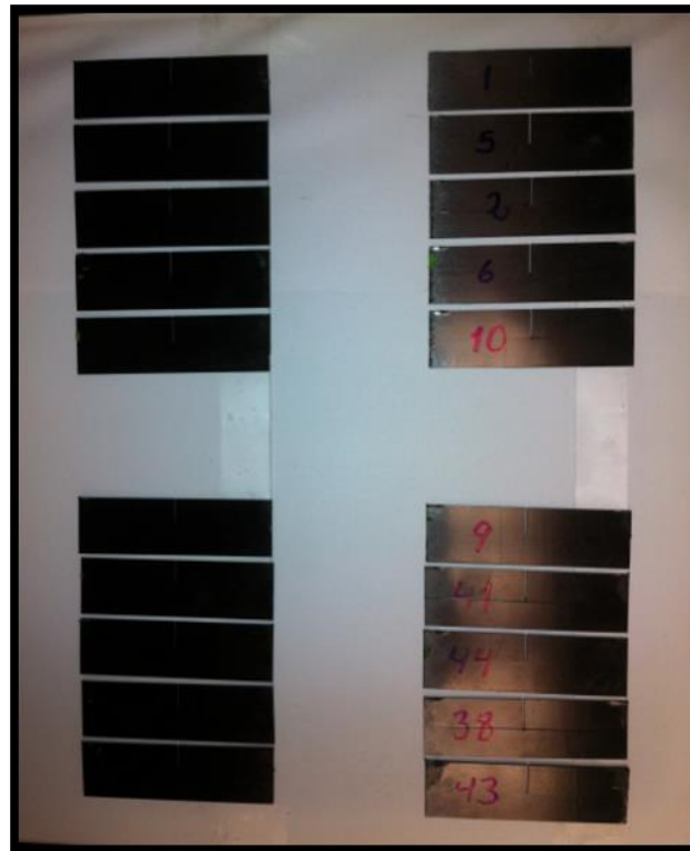
Figura 38.- Probetas útiles después de pruebas de impacto.
