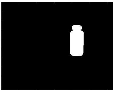
Figura 3.6: Imagen segmentada utilizando la transformada máxima extendida
