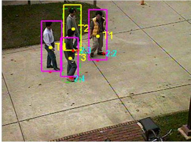
Figura 2.6: Seguimiento de objetos usando una plantilla rectangular [4].
