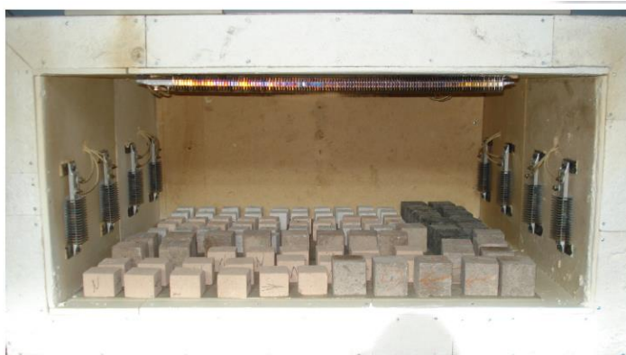
Figura 3.4 Secado de probetas para prueba de absorción de humedad ASTM C97.
