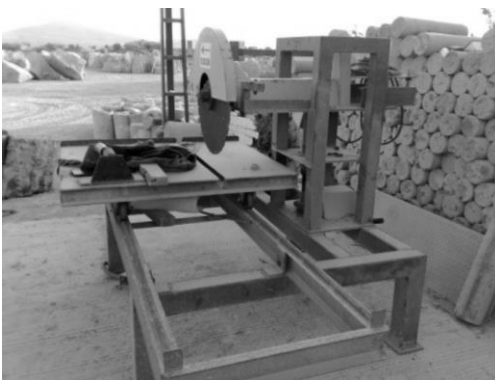
Figura 2.3. Banco de corte de cantera (Imagen en taller de Degollado, Jalisco.).
