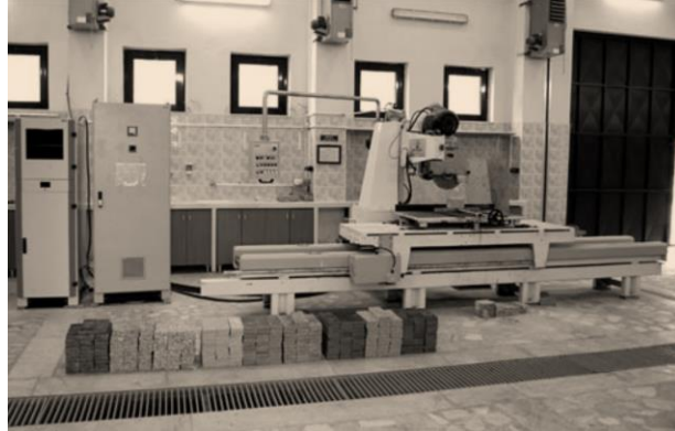
Figura 2.17. Cortador de bloques instrumentada [23].
