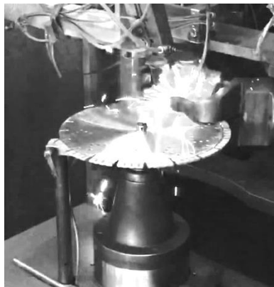
Figura 2.9. Proceso de soldado de segmentos al disco de corte [9].
