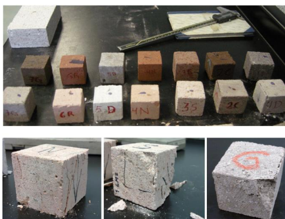
Figura 3.7 Probetas para pruebas de compresión ASTM C170.
