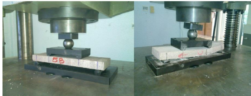
Figura 3.9 Imágenes de prueba de flexión ASTM C880.
