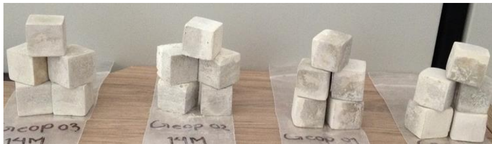
Figura 4.30 – Muestras después del proceso de curado
