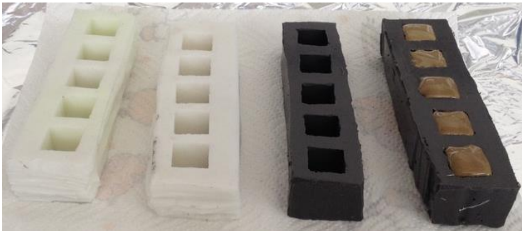
Figura 4.29 – Moldes para la síntesis de muestras
