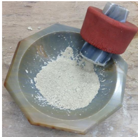
Figura 4.38 – Preparación de muestras para análisis de DRX
