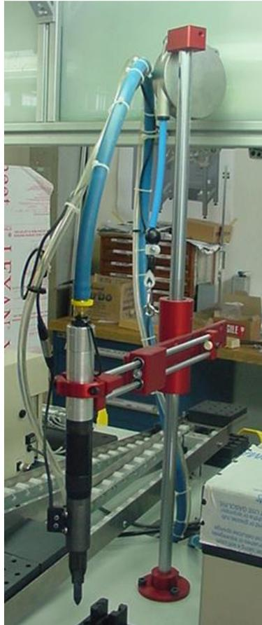
Fig. 26 Brazo atornillador neumático
