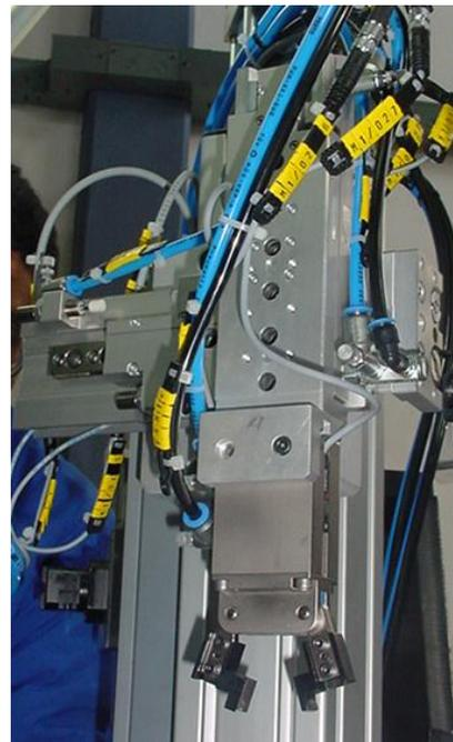
Figs. 22 y 23 Colocación de cilindros para su funcionamiento en conjunto
