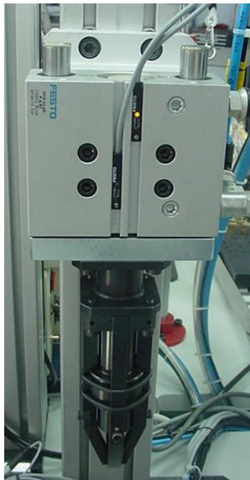
Fig. 28 Sensores magnéticos
