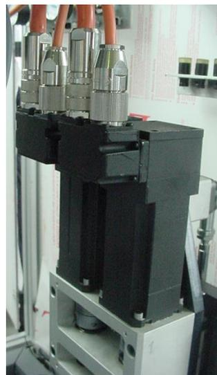
Fig. 39 Servomotores BALDOR
