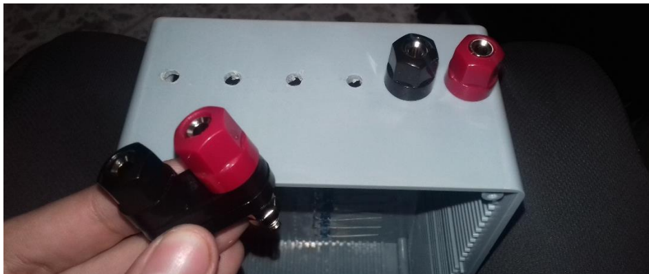
Ilustración 75.- Ensamblado de Terminales hembra
