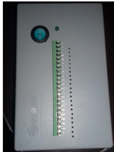
Ilustración 72.- Gabinete con agujeros para borneras
