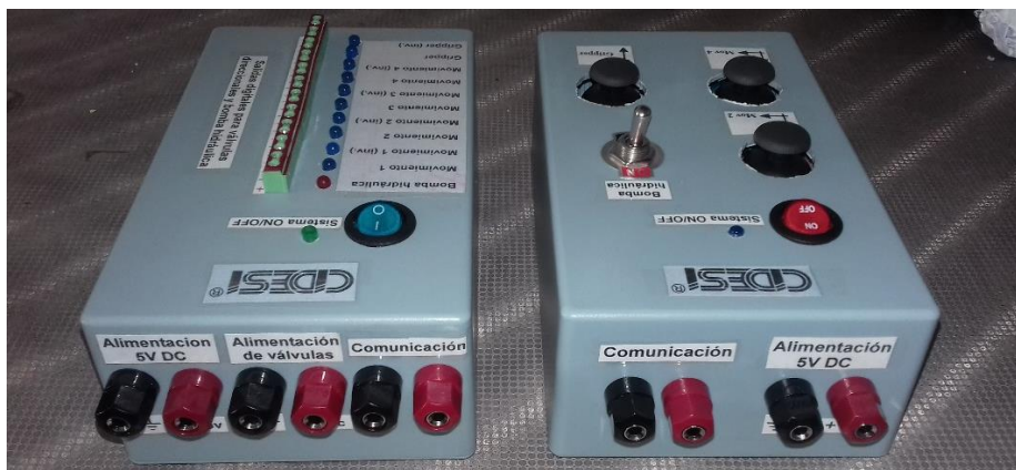
Ilustración 86.- Módulos Transmisor y Receptor terminados
