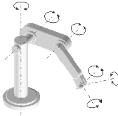
Ilustración 18.- Grados de libertad de un brazo manipulador
