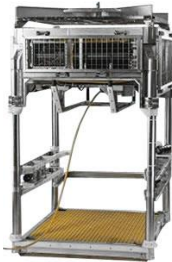
Ilustración 2.- Cabina TMS para alojar al ROV Lynx
