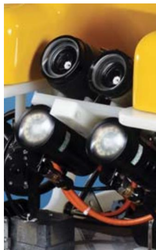
Ilustración 4.- Plataforma de inclinación del ROV Lynx
