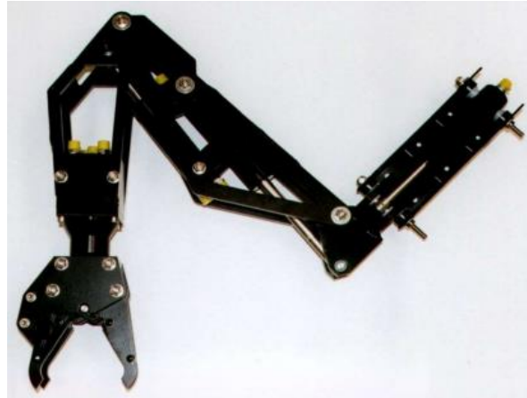
Ilustración 19.- Brazo hidráulico HLK-EH5
