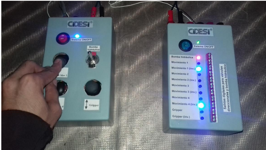
Ilustración 88.- Módulos Transmisor y Receptor (Prueba de funcionamiento)
