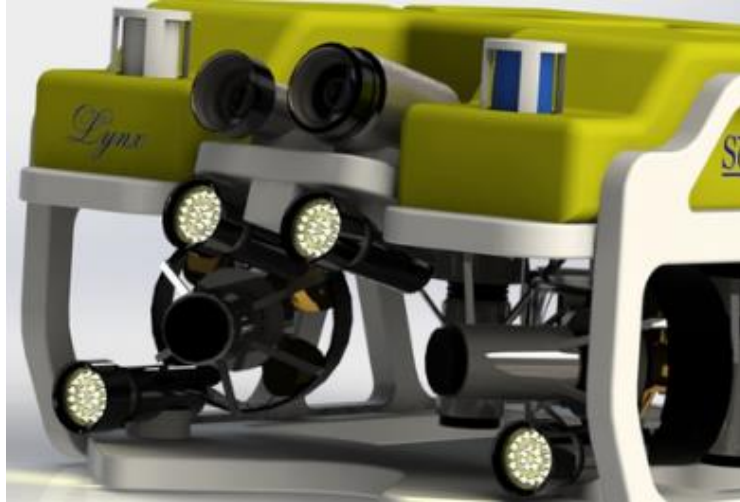
Ilustración 5.- Sistema de iluminación del ROV Lynx
