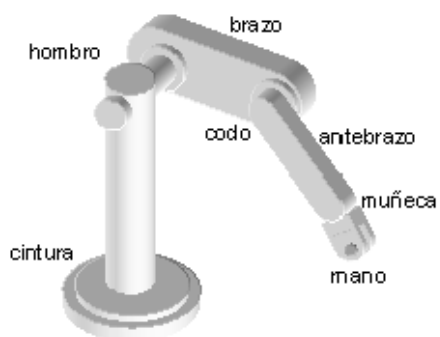
Ilustración 16.- Partes de un manipulador
