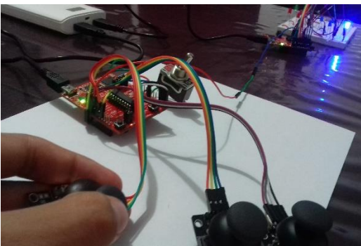
Ilustración 35.- Prueba de circuito transmisor
