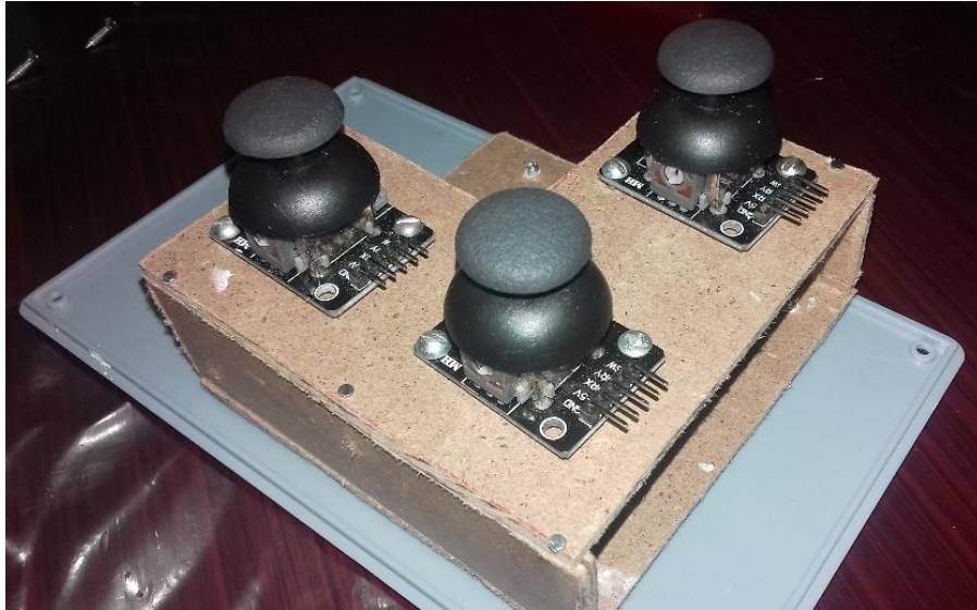
Ilustración 45.- Joysticks montados en estructura de Fibracel
