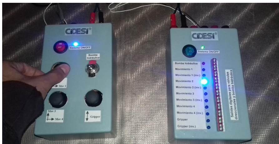
Ilustración 87. Módulos Transmisor y Receptor comunicados
