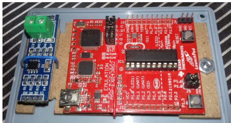
Ilustración 55.- MSP 430 y módulo MAX 485 ubicados en la parte superior del gabinete
