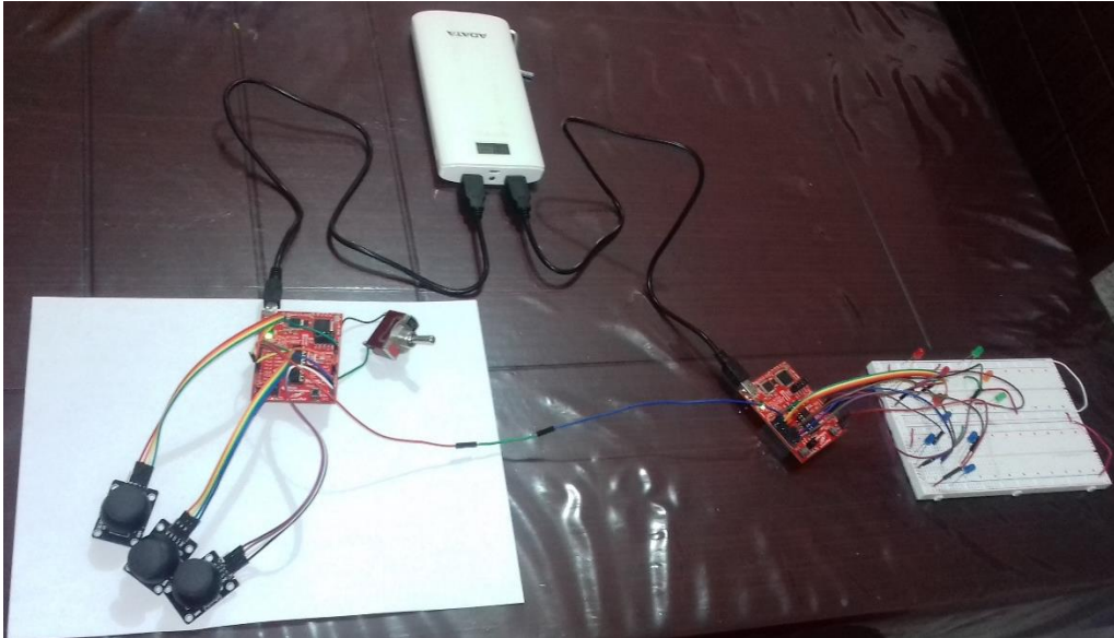
Ilustración 34.- Circuitos electrónicos transmisor y receptor de datos
