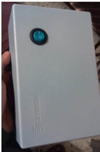
Ilustración 71.- Gabinete con switch de encendido
