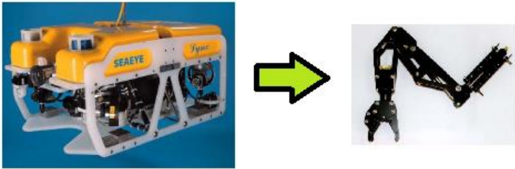
Ilustración 20.- Vehículo ROV Lynx y brazo manipulador hidráulico
