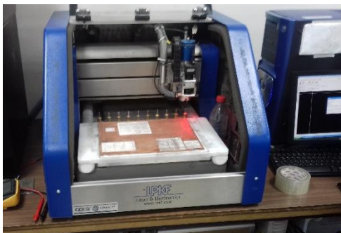
Ilustración 61.- Placa de cobre en CNC
