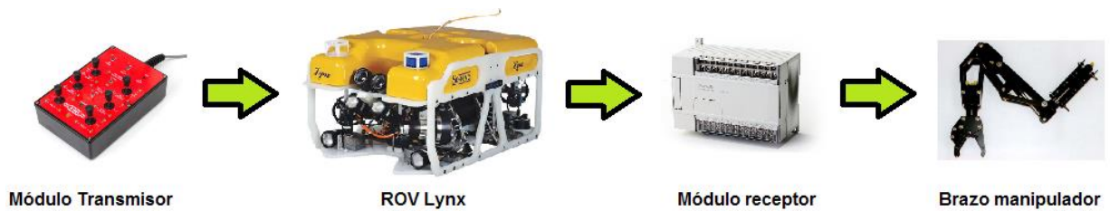
Ilustración 21.- Esquema del sistema propuesto
