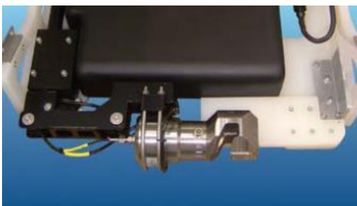
Ilustración 10.- Cortador de cable
