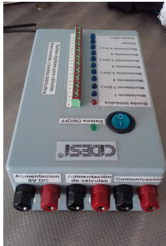
Ilustración 85.- Modulo receptor terminado (vista 2)
