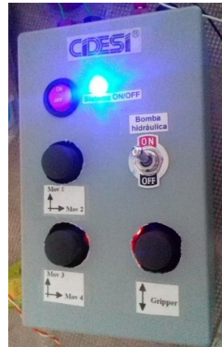
Ilustración 48.- Vista frontal del módulo transmisor
