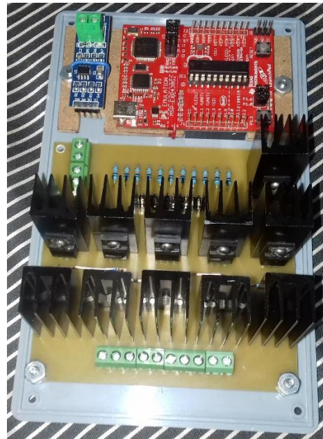
Ilustración 70.- Placa de MOSFETS y módulos fijados al gabinete
