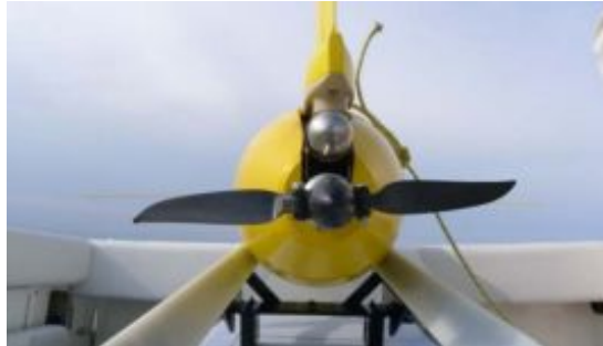
Figura 3. Propela del planeador Slocum G2 (Clayton Jones)
