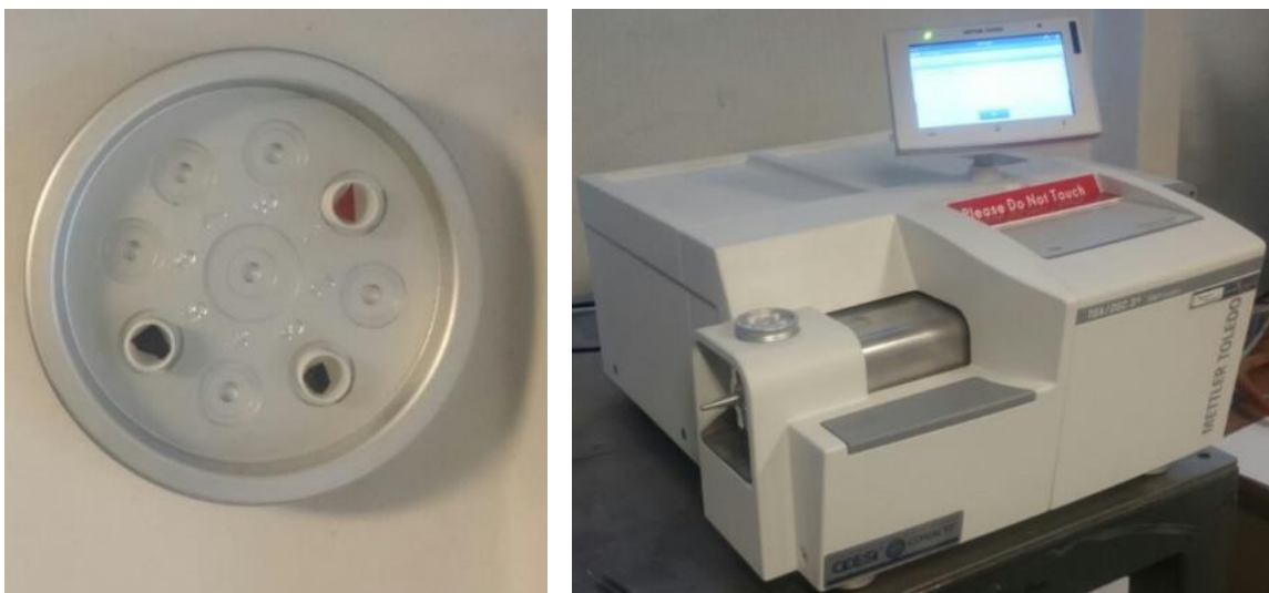
Fig. 19 Análisis termo gravimétrico a) Porta crisol, b) Equipo TGA.
