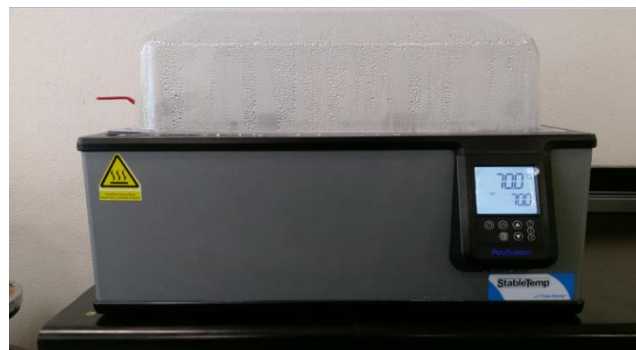
Figura 5.2. Fotografía del baño termostático usado para la inmersión de especímenes de fractura modo I y modo II en agua de mar.
