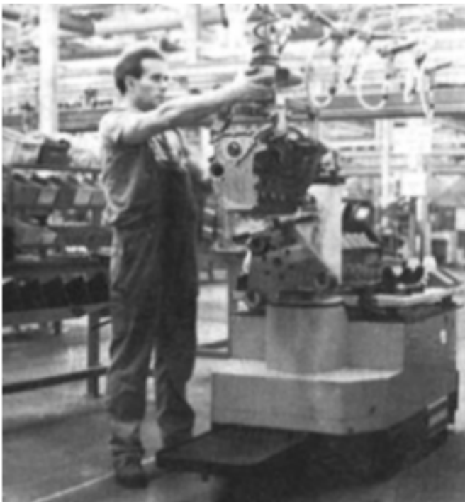
Figura 2.2: AGV de la segunda era. Izquierdo : AGV con guía de inducción en la planta de VW de Salzgitter, 1977. Derecha : AGV de carga Ameise-Teletrak 1970. Fuente: https://jungheinrich.de
