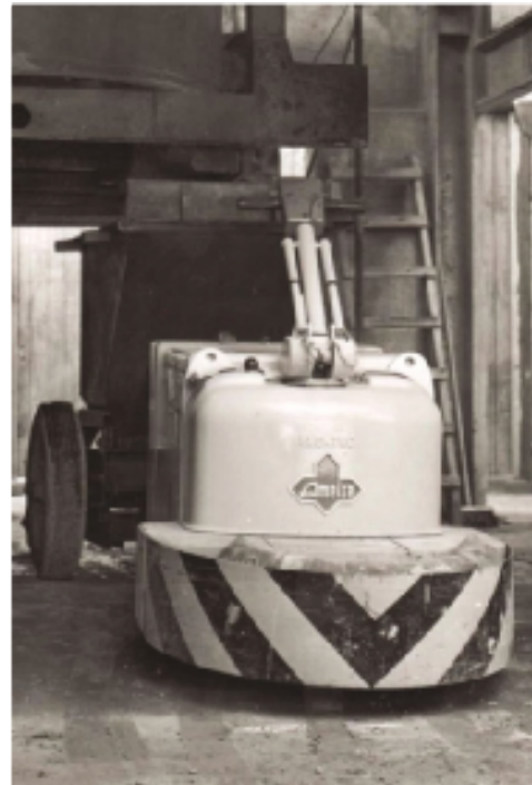
Figura 2.2: AGV de la segunda era. Izquierdo : AGV con guía de inducción en la planta de VW de Salzgitter, 1977. Derecha : AGV de carga Ameise-Teletrak 1970. Fuente: https://jungheinrich.de
