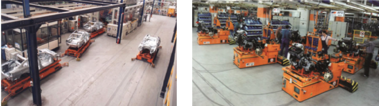
Figura 2.3: AGV de la tercera era. Izquierdo: AGV en la cadena de ensamble del auto Passat en la planta VW de Emden 1990. Derecha: AGV en la línea de ensamble de motores VW Hannover. Fuente: https://ds-automation.com
