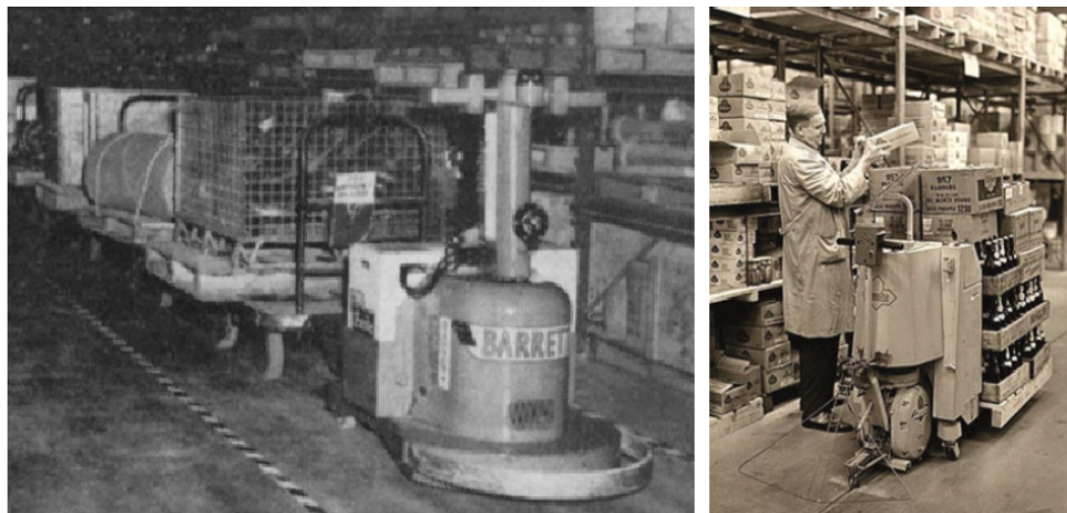
Figura 2.1: AGV de la primera era. Izquierdo: El AGV de Barret Electronic tipo tractor. Derecha: AGV de carga Ameise–Teletrak donde se observa el canal conductor, 1966, Fuente: jungheinrich.de
