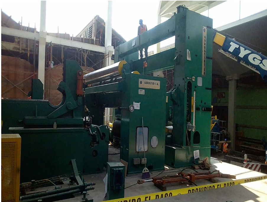
FIGURA 6.16: Armado de embobinadora Gorostidi.
