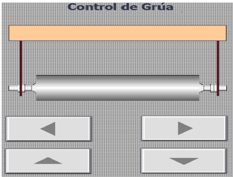
FIGURA 6.14: Control de la grúa para el acomodo de la bobina de alimentación.
