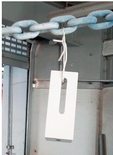
Figura. 49 Muestra uno de los sujetadores del flotador después de haberles aplicado el fondo epoxico primario, para la Boya.
