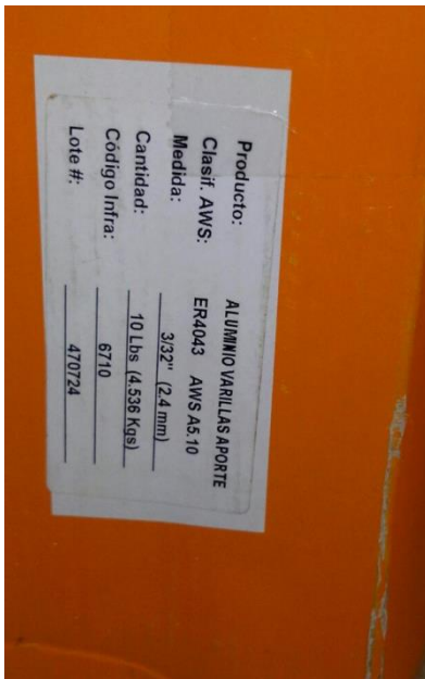
Figura.39 Muestra la soldadura de Aluminio ER4043 AWS A5.10, la cual es necesaria para la fabricación de la estructura superior de la Boya de Monitoreo.
