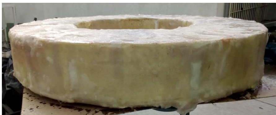
Figura. 45 Muestra el flotador de espuma de poliuretano para la Boya.
