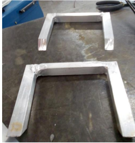
Figura. 46 Muestra las agarraderas de aluminio para maniobrar la tapa y hacer mantenimiento en la Boya.
