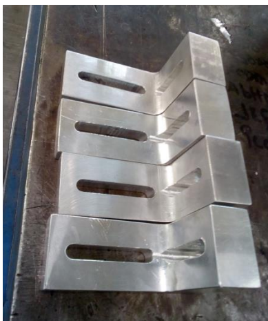
Figura. 44 Muestra los soportes de aluminio que se colocaran para la sujeción del flotador para la Boya.
