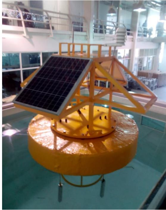
Figura. 54 Muestra la vista frontal de la Boya terminada dentro de la alberca realizando sus primeras pruebas.
