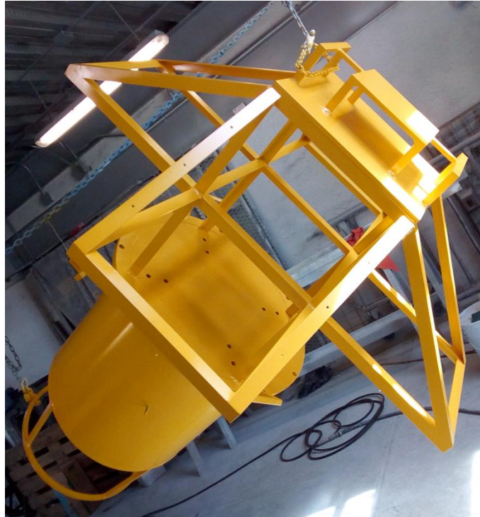
Figura. 52 Muestra todas las partes principales de la boya después de haberles aplicado la pintura amarilla y anticorrosiva, para la Boya.
