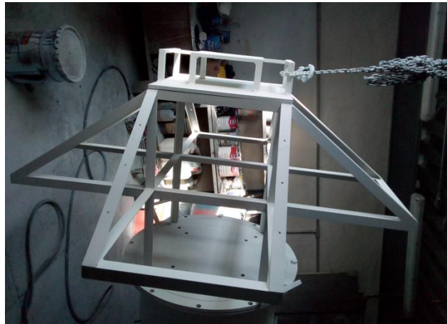
Figura. 47 Muestra la estructura superior después de haberle aplicado el fondo epóxico primario para la Boya.
