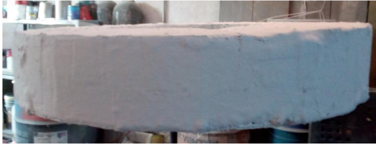
Figura. 50 Muestra el flotador después de haberle aplicado el fondo epoxico primario, para la Boya.
