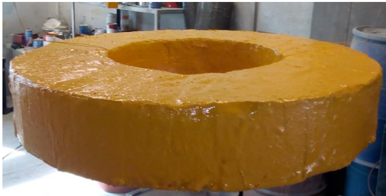
Figura. 51 Muestra el flotador después de haberle aplicado la pintura amarilla y anticorrosiva, para la Boya.
