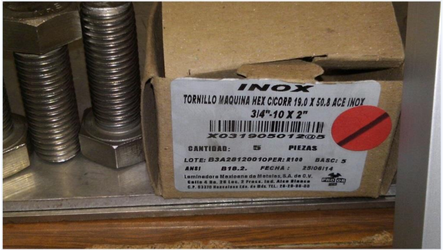
Figura. 40 Muestra los tornillos de Acero Inoxidable para la instalación de la tapa principal de la Boya de Monitoreo.
