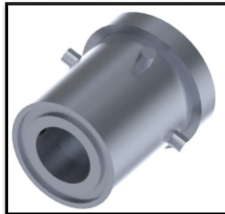
Figura 24.- Camisa para el transductor (Vista lateral).
