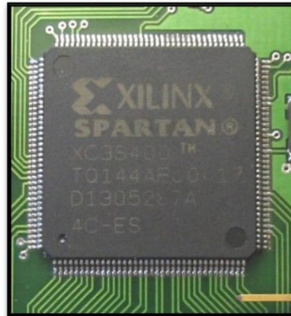
Figura 8.- FPGA marca XILINX modelo SPARTAN.
