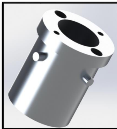
Figura 23.- Camisa para el transductor (Vista frontal).
