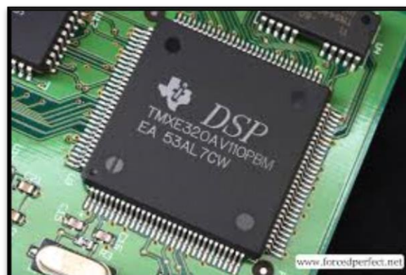
Figura 9.- DSP marca Texas Instrument.
