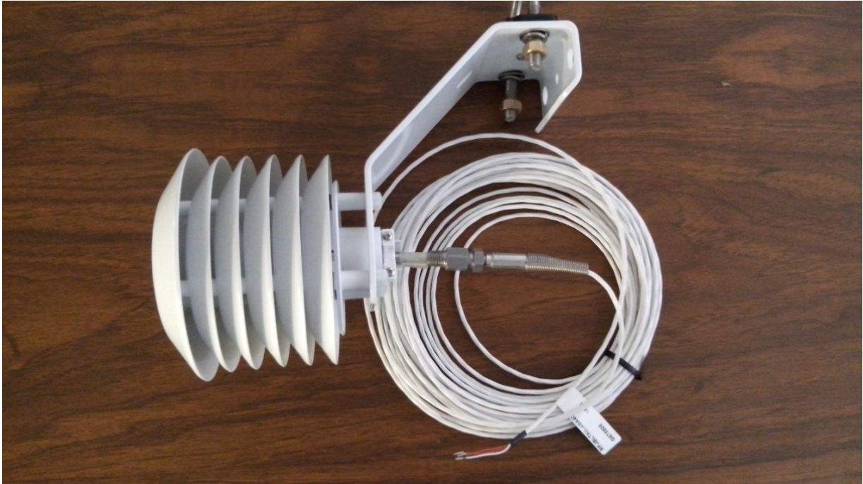
Figura 7: Sensores RTD modelo PT100 para medición de temperatura ambiente.
