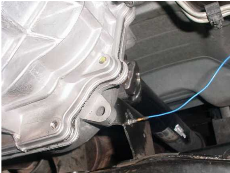
Ilustración 26 Ubicación de Acelerómetro en transmisión
