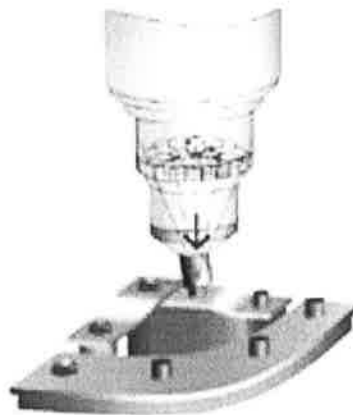
Figura 2.3.3. Herramienta en chuck generando el riveteado.
