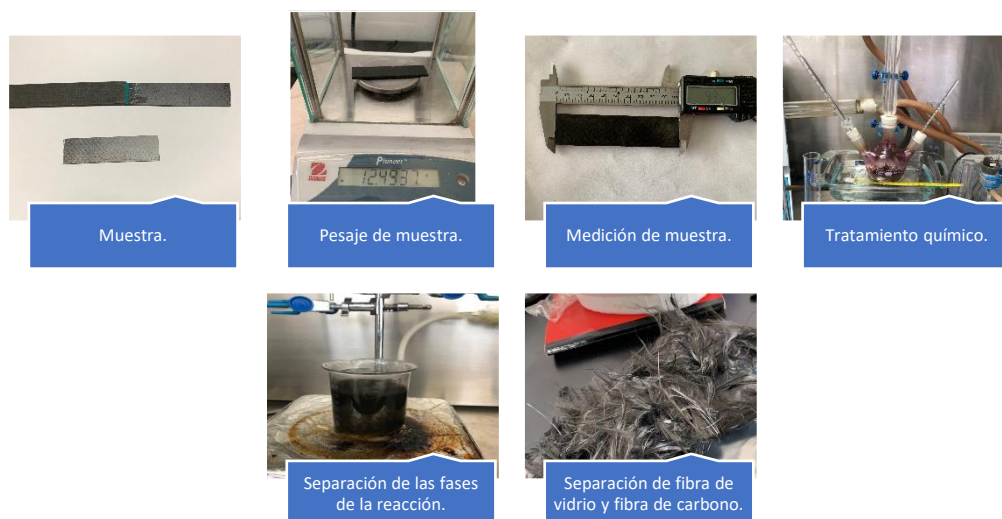
Ilustración 13. Proceso químico para la recuperación de FC (91).
