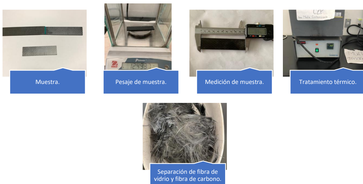
Ilustración 12. Proceso para la obtención de fibra de carbono.
