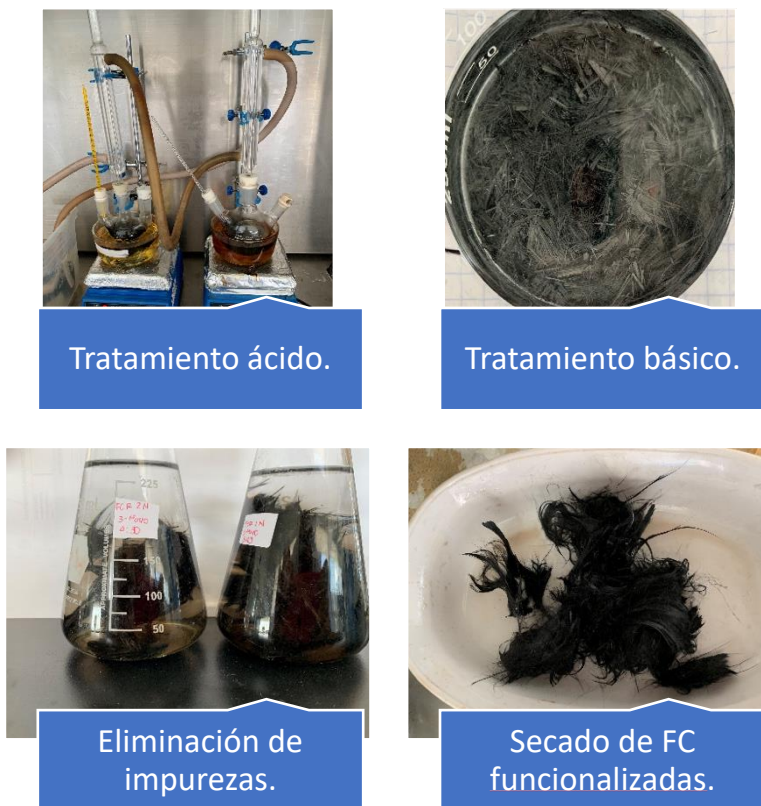
Ilustración 14. Procedimiento general para la funcionalización de FC.
