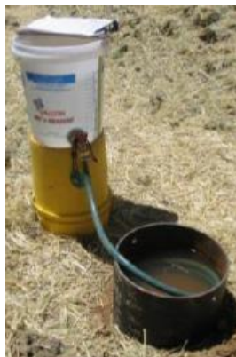
Figura 23. “Anillo permeámetro” (DEP, 2013)
