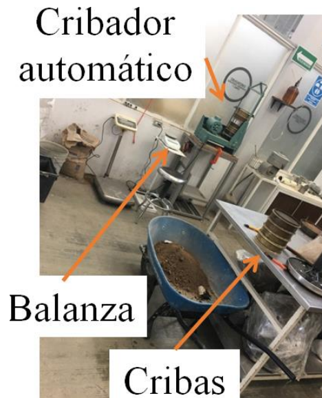
Figura 18. Determinación de la estructura del suelo
