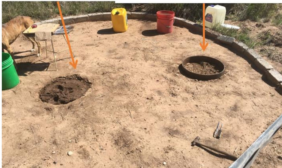
Figura 19. “Anillo permeámetro” de carga constante
