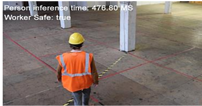
Ilustración 2.13: Solución de notificador de zona restringida.
