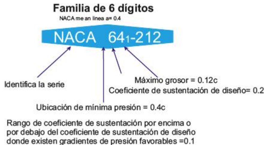
Figura A1.5. Designación de los dígitos del perfil aerodinámico NACA de serie 6 [11].
