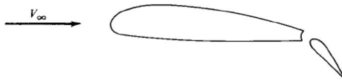
Figura 5.14: Flap simple de un ala, en un estabilizador horizontal se conoce como elevador [2].
