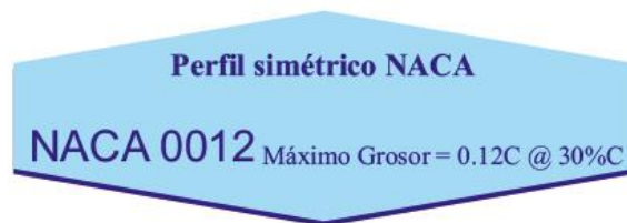
Figura A1.2. Designación de 4 dígitos del perfil aerodinámico NACA simétrico [11].
