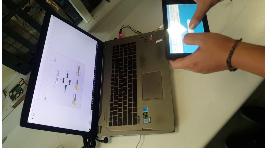
Figura 4.2: Comunicación serial entre la interfaz y la computadora para el ajuste de los parámetros del funcionamiento del robot.
