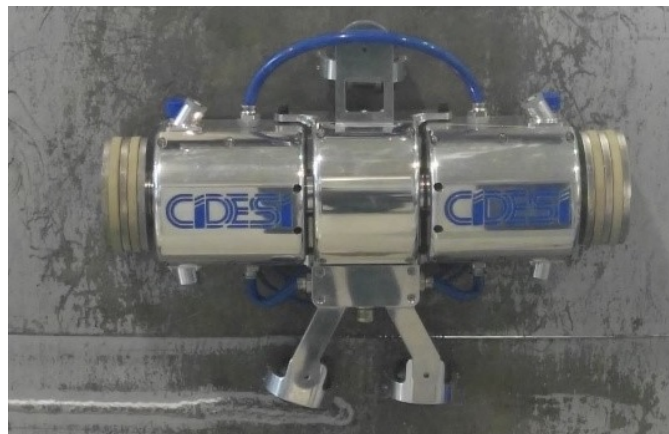
Figura 2.5: Robot explorador Desarrollado en CIDESI segunda generación
