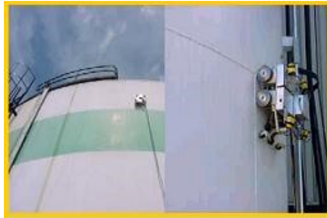
Figura 2.4: Robot explorador Desarrollado en CIDESI primera generación
