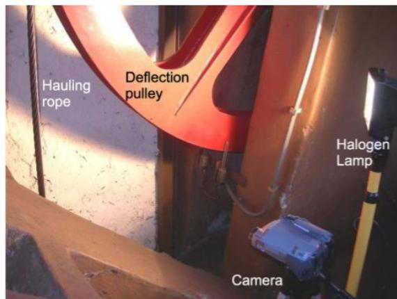
Figura 6.3: Método de medición de cable.
