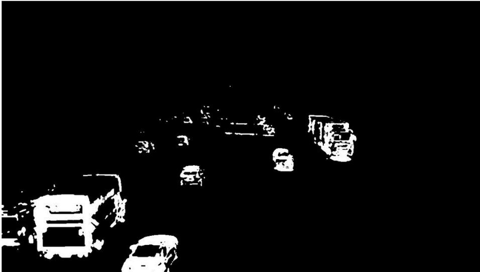
*Ilustración 7. Simple Thresholding.*
