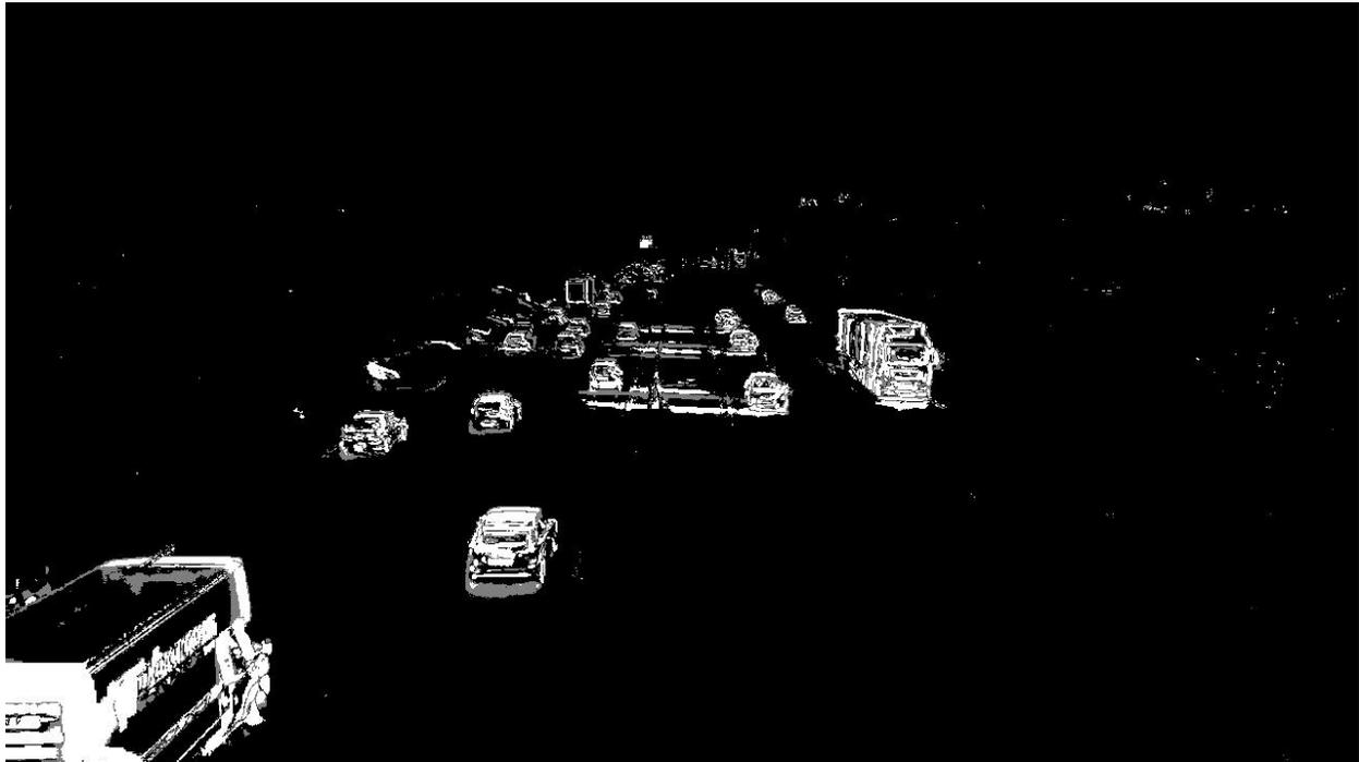
*Ilustración 6. Eliminación de fondo usando algoritmo MOG2 con entrenamiento.*
