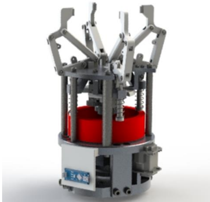
Figura 5-12 Renderizado del diseño definitivo del gripper reconfigurable de cuatro dedos.
