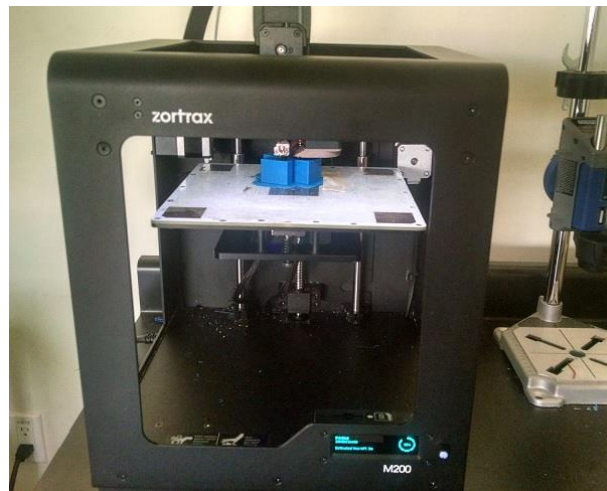
Figura 5-2 Impresión 3D de componentes en la prototipadora Zortrax M200.
