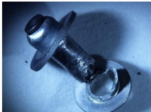
Figura 23. a) Fallo en el cojinete, b) falla por cortante en remaches de 5/32
