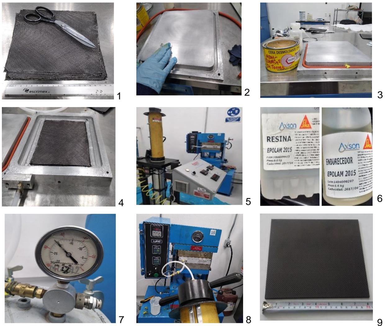
**Figura 8.** Pasos realizados para el proceso de fabricación del minado de carbono/epoxi por el método de manufactura por RTM
