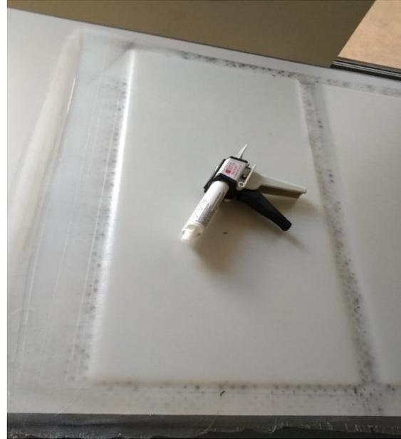
**Figura 29** a) Placa de fibra de carbono de 300 x 300 mm b) placa de fibra de vidrio para elaboración de tabs
